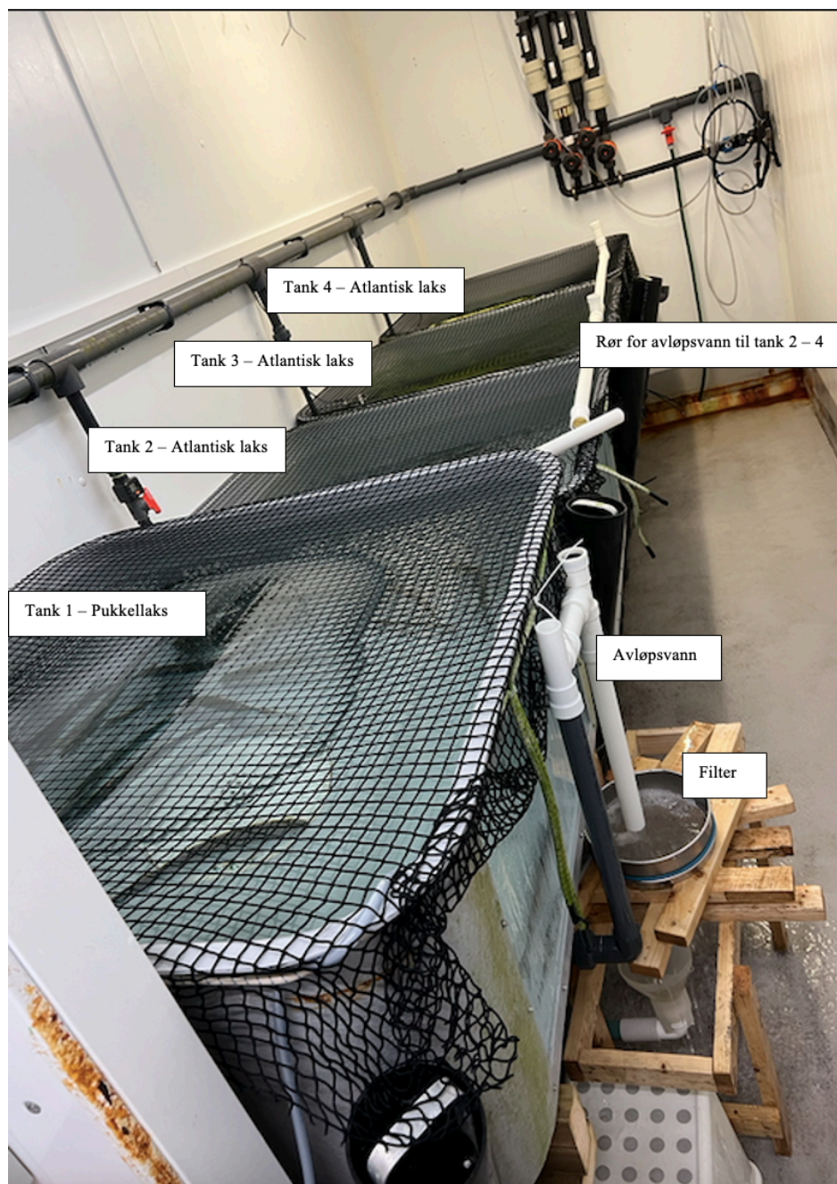
Figur 8: Eksperimentelt oppsett ved hovedforsøk. Tank 1 inneholder 29 pukkellaks og tank 2-4 inneholder hver 12 Atlantisk laks. På bildet filtreres avløpsvann fra tank 1, mens avløpsrørene til tank 2-4 ikke er aktive.
