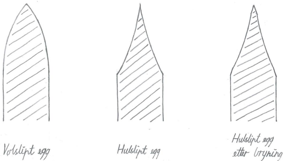
Figur 1.2: Forskjellen mellom volslipt egg og hulslipt egg, samt hulslipt egg etter bryning. Legg merke til at slipefasen til den brynede hulslipte eggen får to flate partier etter bryning, ett ved selve eggen, og et ved overgangen mellom slipevasen og redskapets sider. Tegnet av Bendik N. Bergendal.
