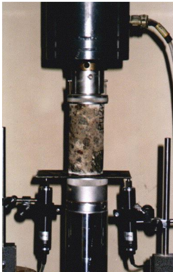
BILDE 5:ET VANLIG TESTOPPSETT FOR Å FINNE UCS EMPIRISK. ELASTISITET KAN FINNES PÅ SAMME MÅTE.
