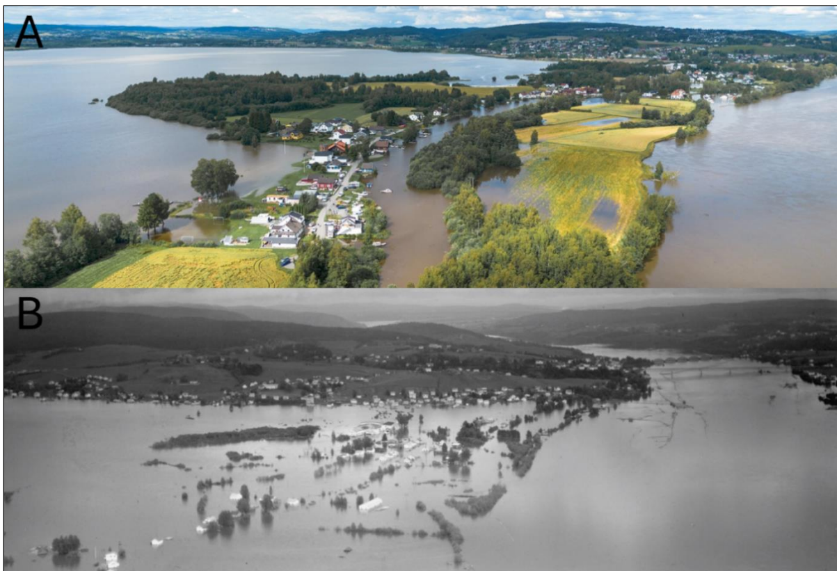
Figur 2.6: Øya i Fetsund sett mot nord med Svelle til venstre og Glomma til høyre, under ekstremværet Hans i 2023 (A) og storflommen i 1967 (B), hvor vannstanden i Øyeren kulminerte på henholdsvis 103.44 og 106.61 meter. Vannstanden i 1967 er den høyeste siden storflommene i 1860 og Stofosen i 1789, og tiltak for å senke utløpet ble gjort i etterkant. Effekten av dette medfører at tilsvarende flommer med like stor vannføring, som Vesleofsen og Hans, ikke øker Øyerens vannstand på samme måte som tidligere. Foto: A) Lisbeth Lund Andersen, B) K. Haugen/Museene i Akershus.
