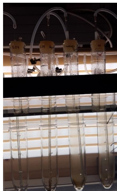
Figur 20: Dyrkningsrørene plassert i akvariet som er fylt med ferdig temperert vann. På toppen ser vi slangene som er koblet til rørene for å tilføre luft med CO 2 . Foto: Hege Kvamme
