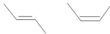
Figur 10: Skjematiske framstillinger av dobbeltbindingene i umettet fettsyrer. De kan enten være i Trans-form som er en rett form, eller i en Cis-form som er en bøyd form.
