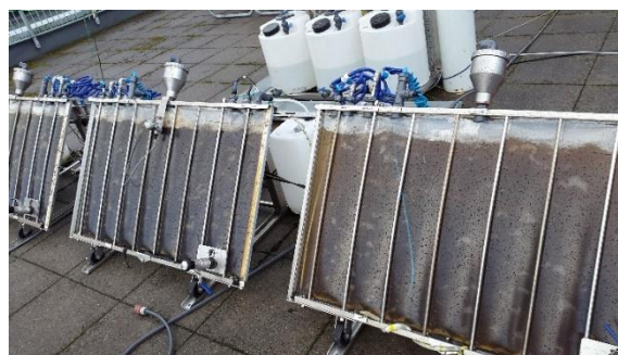
Figur 5: Et lite utendørs algedyrkingsanlegg. Foto: Hege Kvamme
