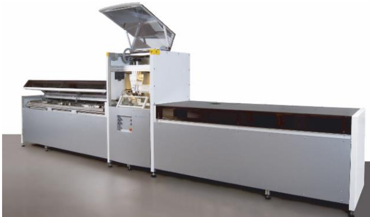
Figur 3.6. ITRAX XRF kjerneskaner. Kjernen plasseres til venstre der hetten er åpen og forflyttes mot måletårnet (i midten). Detaljbeskrivelse av måletårnet er vist i Figur 3.7. Figuren er hentet fra Croudace et al. (2006).
