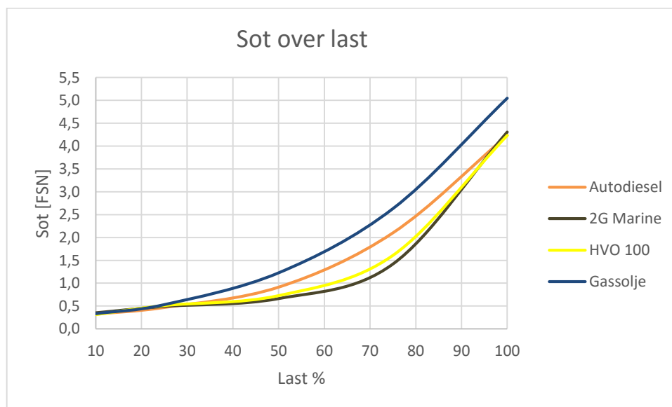
Figur 53: Sot og partikler målt i avgass
