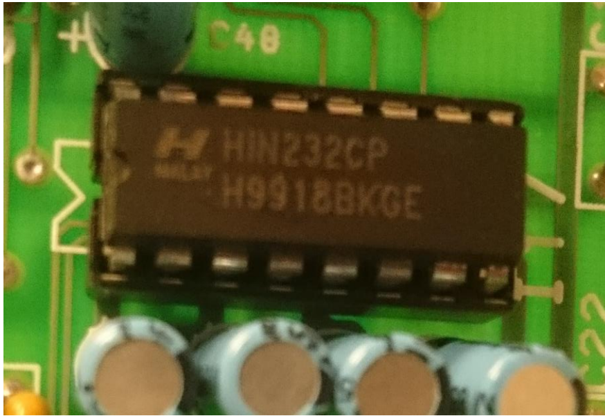
Bilde 49: HIB232CP - transmitter/mottaker
