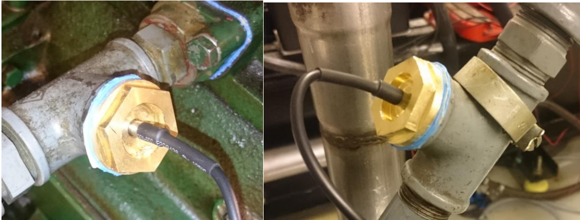
Bilde 22: Temperatursensorer før (til venstre) og etter (til høyre) motor
