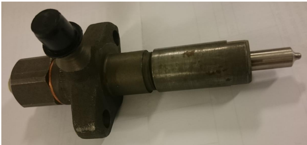
Bilde 6: Bryce innsprøytningdyse med dyseholder
