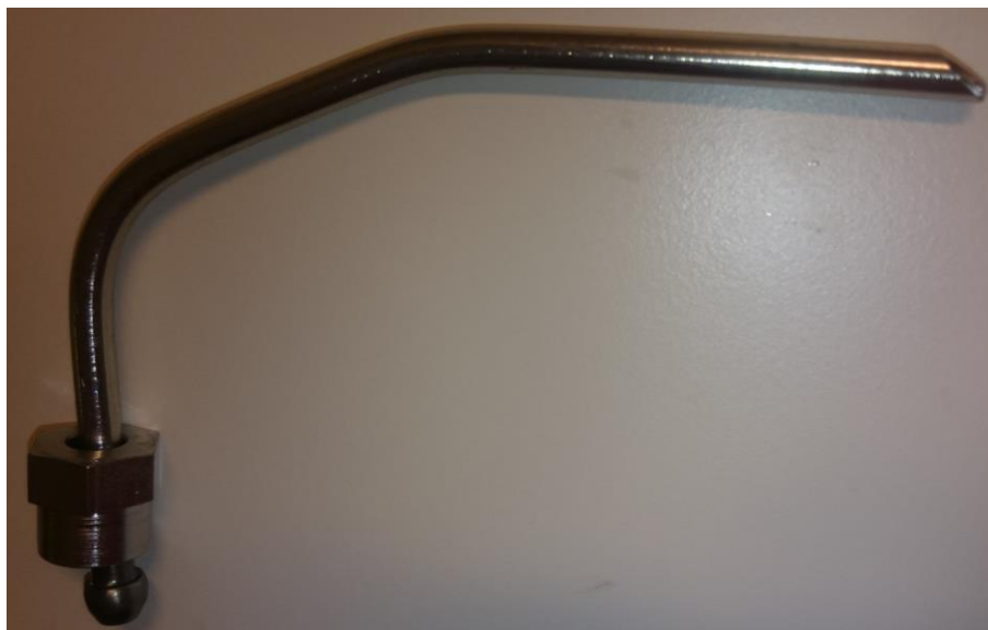
Bilde 55: Vinkelrør til testing av leveringstidspunkt fra pumpe
