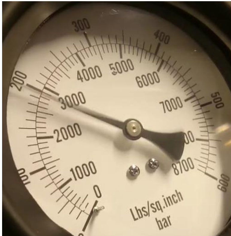
Bilde 10: Åpningstrykk original dyse
