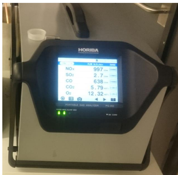
Bilde 26: Horiba NO x -analysator ved HiB
