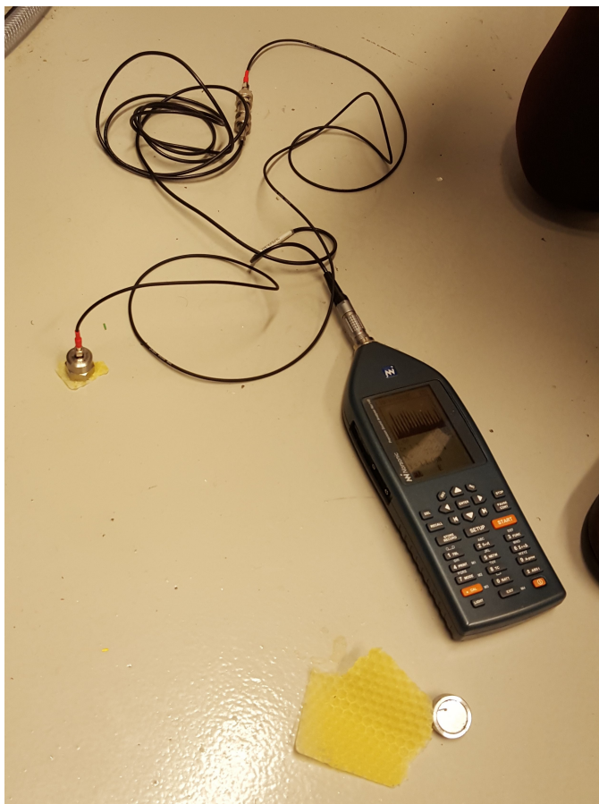
FIGUR 3.5: Vibrasjonsmåling på gulv i maskinrom. For å feste måleren til gulvet brukte man honningvoks.
