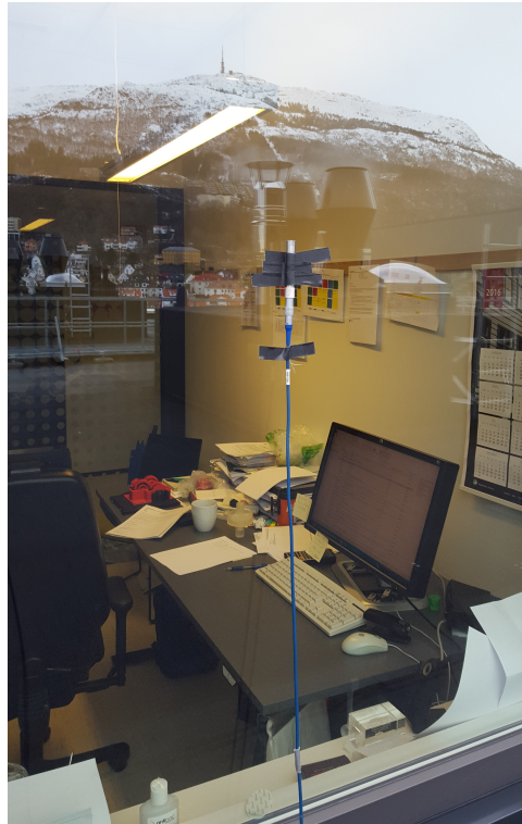
FIGUR 3.3: Lydmåling på fasade. Mikrofon teipet til vindu. Siden det var vindstille var det ikke nødvendig med vindhette. Bilde av avkasthette reflekteres av vinduet.
