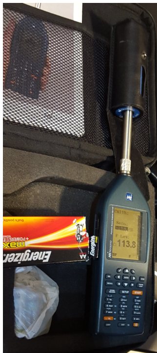
FIGUR 3.2: Feltkalibrering av lydmåler med 1000 Hz ren tone på 114 dB.
