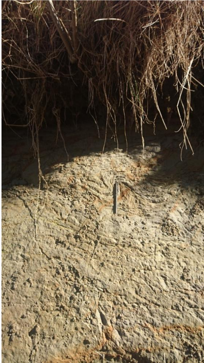
Figur 3.27 Helt sør-vest i feltområdet ligger det et lite snitt ovenfor en ridebane. I snittet er det eksponert silt og leire. Toppen av snittet ligger ca. 22.5m o.h.
