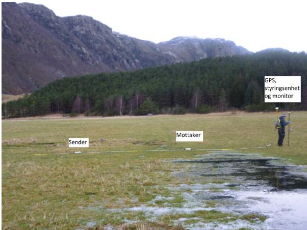
Figur 2.3 Georadarsystemet som er brukt i undersøkelsen kommer fra Malå geoscience og består av en 25Mhz RTA antenne som inneholder sender og mottaker, styringsenhet, monitor og GPS. Foto: Oliver Grant.
