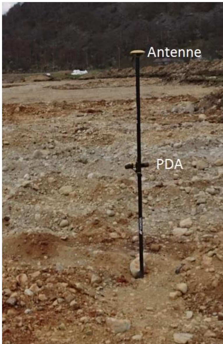
Figur 2.23 TOPCON GRS-1 Differensiell GPS-system. Systemet består av en kombinert GSM og GPS-antenne på toppen av stangen, og en PDA midt på stangen som brukes for å styre hele systemet.
