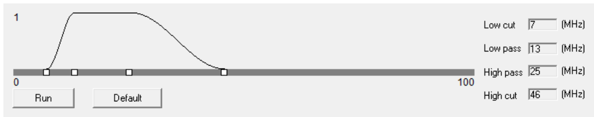
Figur 2.20 "Bandpass" filteret som ble brukt til dataene ble satt til å ha "low cut": 7MHz, "low pass": 13MHz, "high pass": 25MHz og "high cut": 46MHz.
