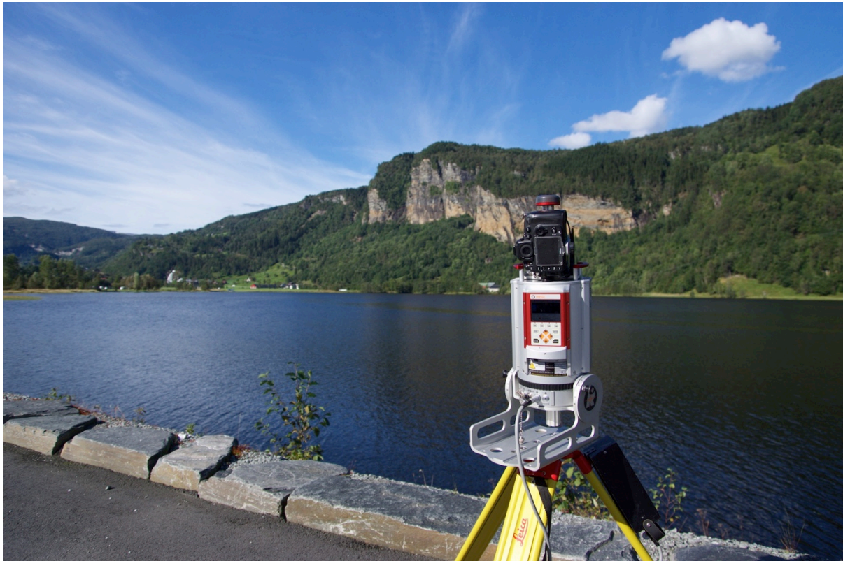
Figur 17: Riegl VZ-1000 med et Nikon D 800E kamera og GPS-antenne montert oppå.
