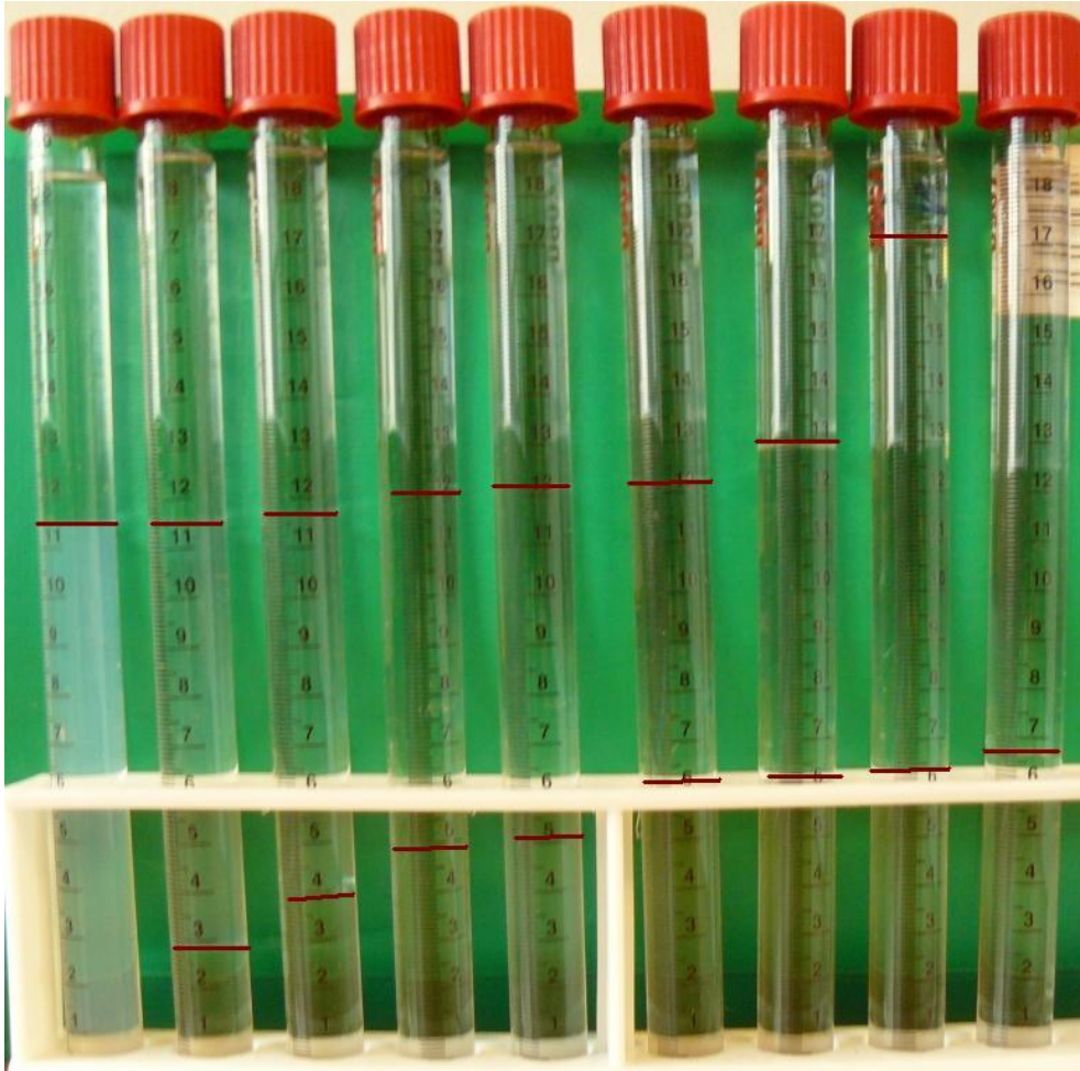
Figur 6-2: Figuren viser en skanning av et system med økende salinitet. De røde strekene marker faseoverganger. Systemet endrer faseoppførsel fra Winsor I til Winsor III til Winsor II fra venstre til høyre.
