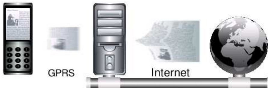
Figure 3.2: Når en bruker surfer på nettet med Opera Mini, blir forespørselen sent via Genera Packet Radio Service (GPRS) til en av Opera Software sine proxytjenere. Tjeneren vil så hente siden, prosessere, komprimere og sende den tilbake til brukerens mobiltelefon.
