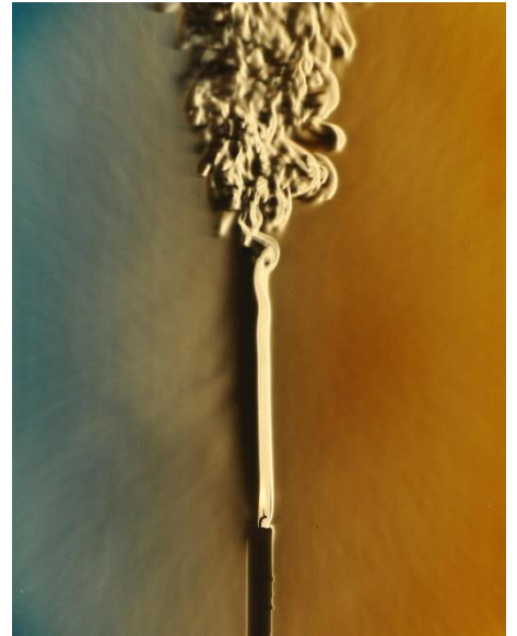
Figure 3.2: Overgangen fra laminær til turbulent strøm. Foto: Gary Settles.
