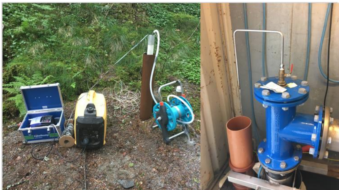
Figur 5.5: Bilete til venstre viser prøvetaking frå ein observasjonsbrønn, med ei flyttbar pumpe. Bilete til høgre viser prøvetaking frå ein produksjonsbrønn der det er installert ei pumpe og tappekran. Foto: Line Haukanes.
