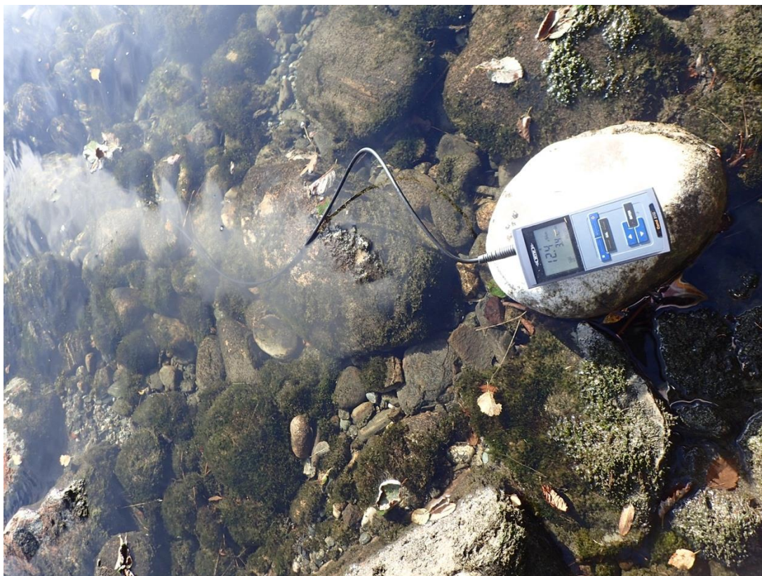
Figur 5.6: Bilete viser instrumentet brukt til å måla den elektriske leiingsevna i vatn. Her vert det nytta til å måla leiingsevna i elva Raundalselvi. Foto: Line Haukanes.
