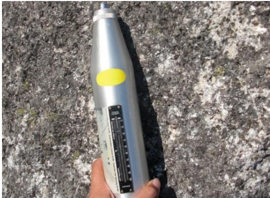
Figur 7.6: Gammel flate det ble tatt målinger på til kalibreringskurven. Foto: Ane Senneseth
