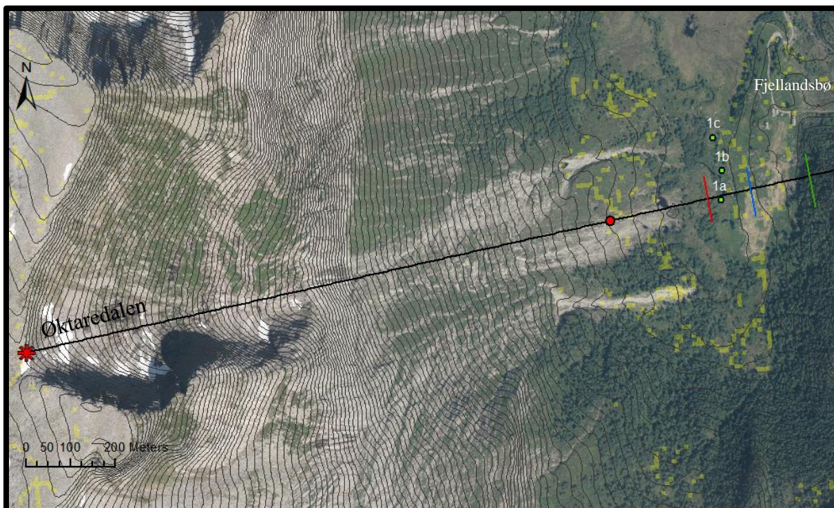
Figur 8.1.11: Maksimum utløpslengder for snøskred beregnet med alfa-beta metoden på Lokalitet 1. Den svarte linjen viser skredbanen. Løsnepunktet er markert med rød stjerne. 10^\circ -punktet er markert med rød prikk. Grensene til sikkerhetsklasse S1, S2 og S3 er markert med henholdsvis rød, blå og grønn strek. Blokkene kartlagt i felt er markert med grønne prikker. De gule feltene er der terrenget har en helning på 10^\circ . Modifisert flyfoto fra Kartverket (2017b)
