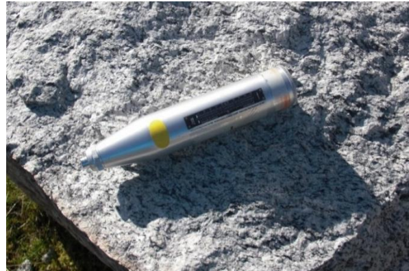
Figur 7.7: Fersk flate det ble tatt målinger på til kalibreringskurven. Foto: Ane Senneseth
