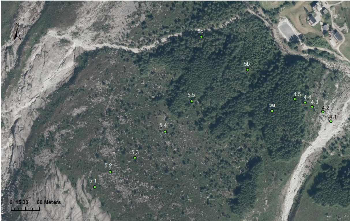
Figur 8.5.9: De grønne prikkene i dalsiden representerer profilet det er tatt schmidthammermålinger på på Lokalitet 5. Profilet starter øverst i dalsiden, der det er tatt målinger på fem blokker nedover. Øverste blokk er kalt 5.1, neste 5.2 osv. Modifisert flyfoto fra Kartverket (2017b)
