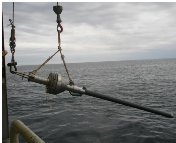
Figur 3.4 Bildet viser fallkjerneprovvetakeren ombord på «G.O. Sars» (Haflidason et al., 2017)
