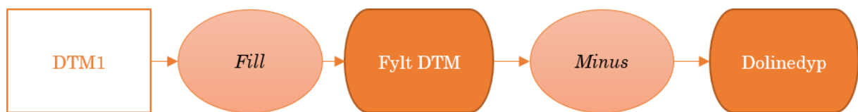
Figur 4.6 Fremgangsmåte for produksjon av dybderaster i ArcMap.
