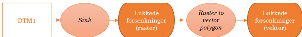
Figur 4.4 Flytskjema illustrerer fremgangsmåte for produksjon av lukkede forsenkningpolygoner i Whitebox GAT.
