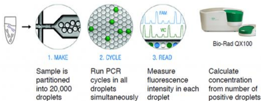
Figur 1.8: Trinnvis fremstilling av hvordan DNA blir kvantifisert ved bruk av ddPCR metoden (Christof Winter, 2016).
