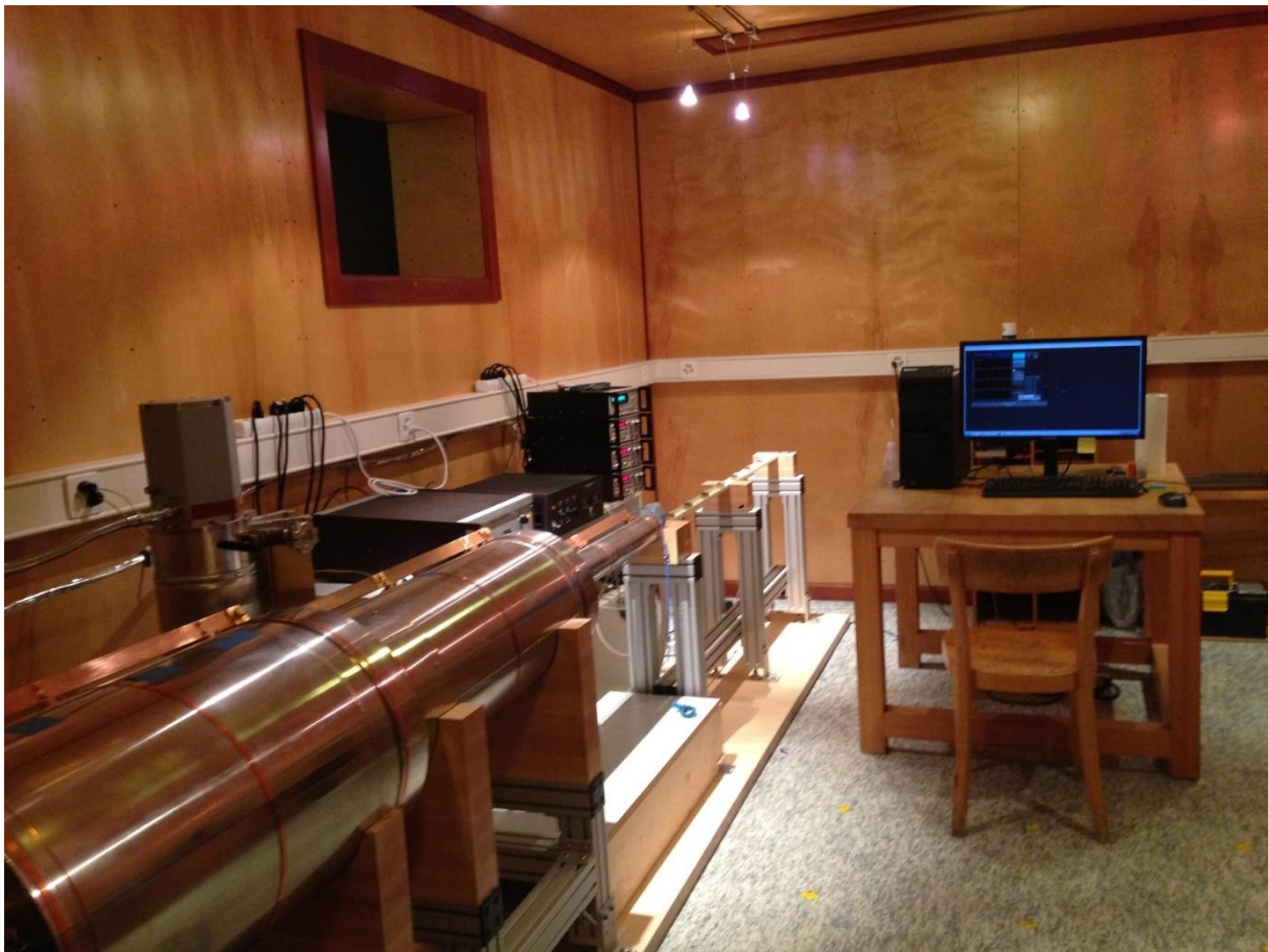
Figur 3.5. Til venstre i bilete kan ein sjå DC-SQUID Rock magnetometer som vert brukt til å måle blant anna ARM. Til høgre kan ein sjå PC-en som er utstyrt med programvara 2G Long Core, Version 3.4AllSMC, frå 2G Enterprises, Copyright ©2007, som igjen nyttast til å styre magnetometeret. Biletet er henta frå http://www.epm.ethz.ch/lnm/laboratory/shielded-room.html .
