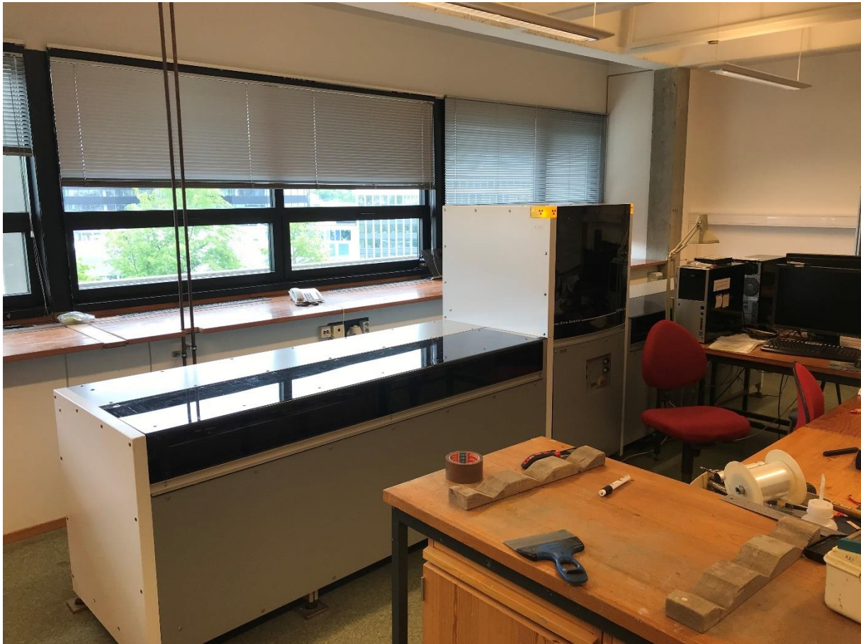
Figur 3.2. Figuren viser eit bilete av ITRAX kjerneskanaren på EARTHLAB ved UiB. Kjernen vert plassert på ein skinne i delen til venstre for «tårnet» til skannaren. Deretter vert kjernen frakta til høgre gjennom «tårnet» der sjølve skanninga vert gjort. Foto: Monika Øksnes
