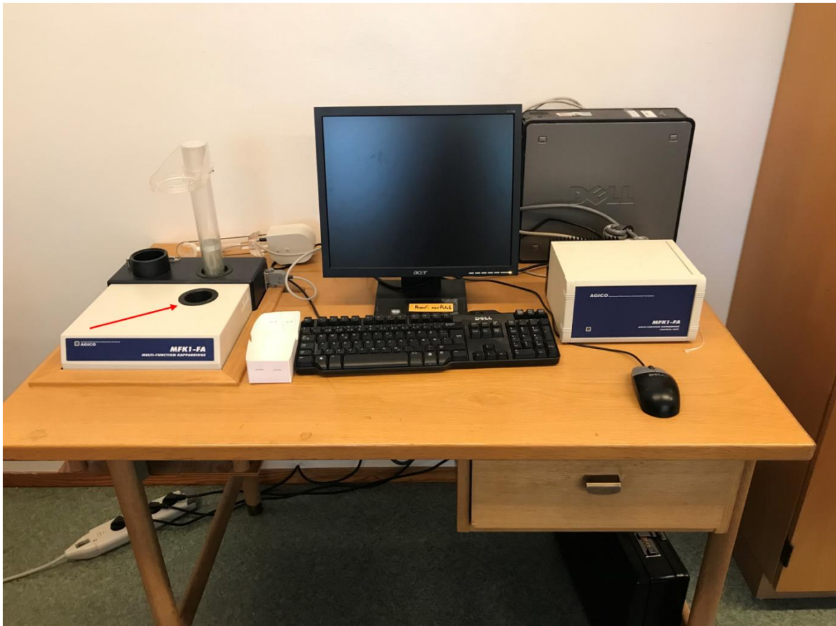
Figur 3.4. Figuren viser instrumentet Agico MFK1-FA Kappa brigde som står på EARTHLAB ved UiB. Den raude pilen indikerer kvar prøvane vert plasserte for å måle dei. Systemet vert styrt ved hjelp av programmet Safyr4W på datamaskinen i midten. Foto: Monika Øksnes
