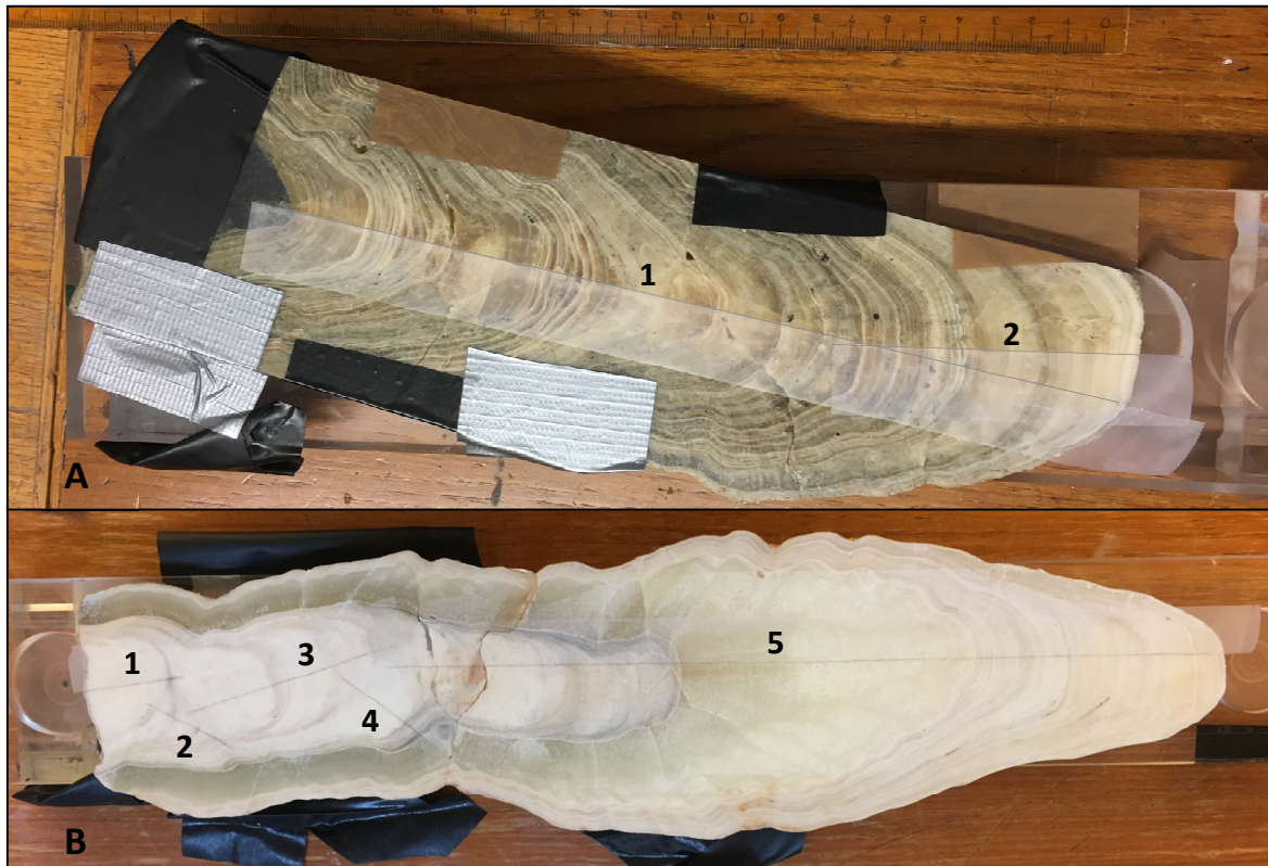
Figur 4.5: Markerte vekstretninger for A) prøve WA-1 ; seksjon 1 og 2, og B) prøve BL-3B; seksjon 1, 2, 3, 4 og 5. Linjene er ikke representable for lengden av seksjonene.
