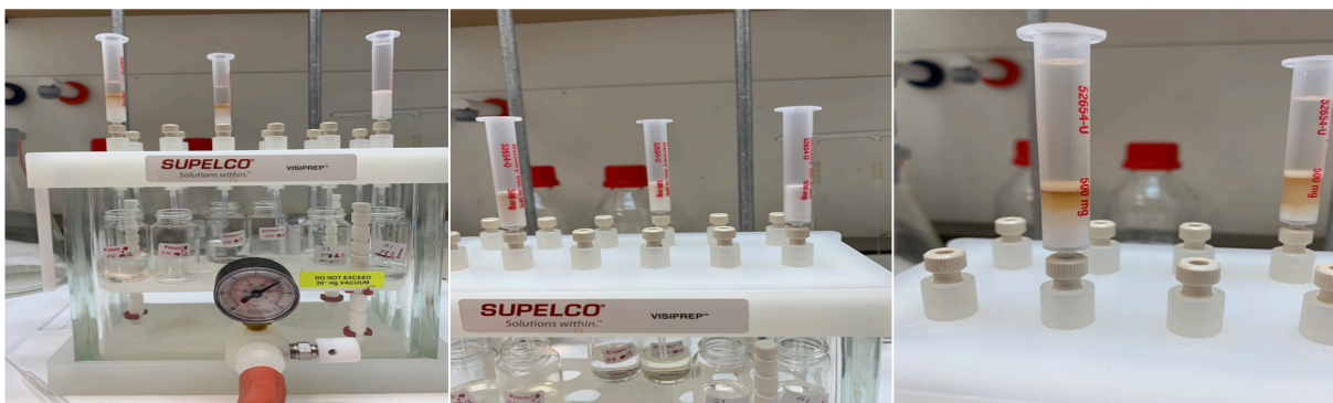
Figur 4.9: Oversikt over SPE oppsettet med kolonner. Bildet viser fast fase ekstraksjon av tre forskjellige oljeprøver.
