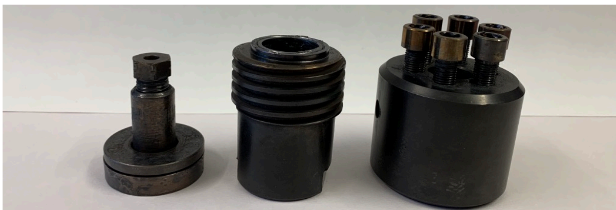
Figur 4.2: Viser de tre hoveddelene i reaktoren. Fra venstre vises topp, bunn og topplokk.
