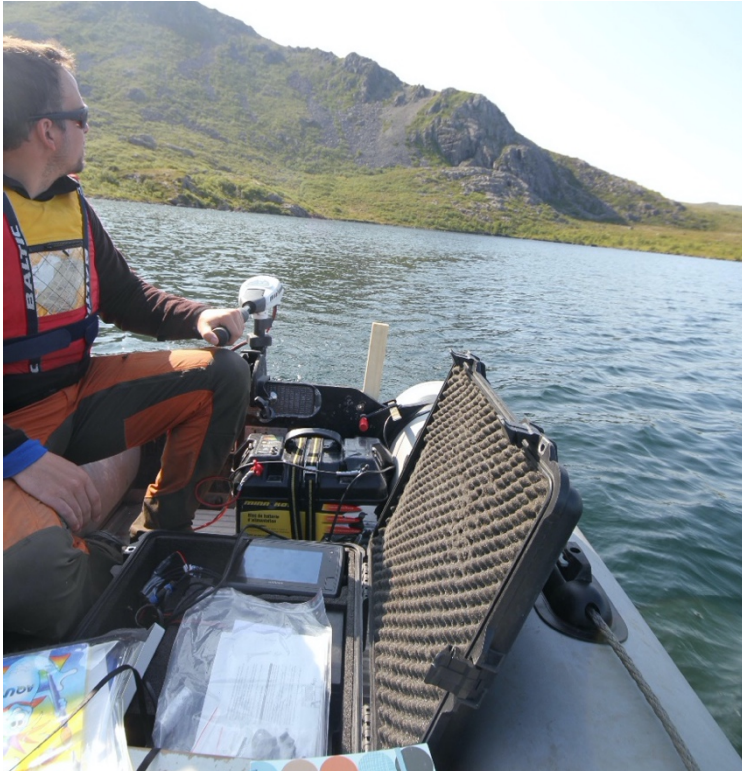
Figur 4.3: Innsamling av batymetrisk data i felt ved bruk av ekkolodd av typen Garmin GPSmap, 721 xs.
