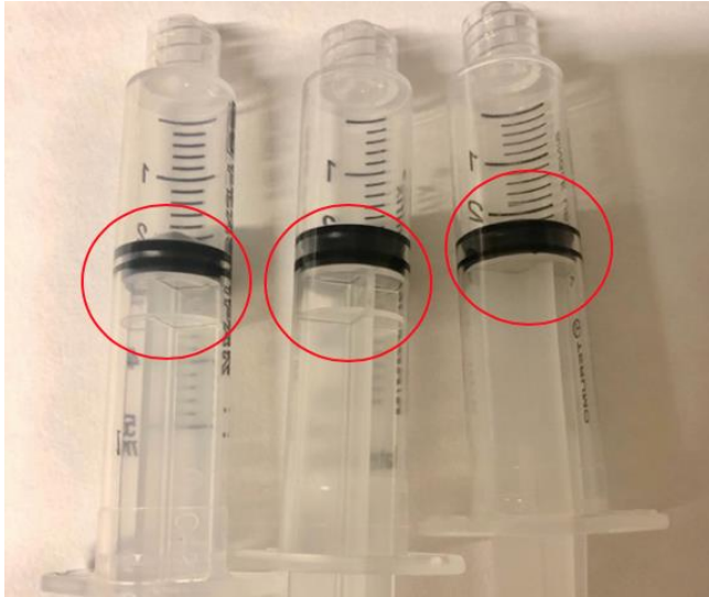
Figur 23: Bildet illustrerer forskjellen på sprøytene fra BD Plastipak (til venstre), B. Braun Omnifix (i midten) og Terumo (til høyre) (eget bilde).
