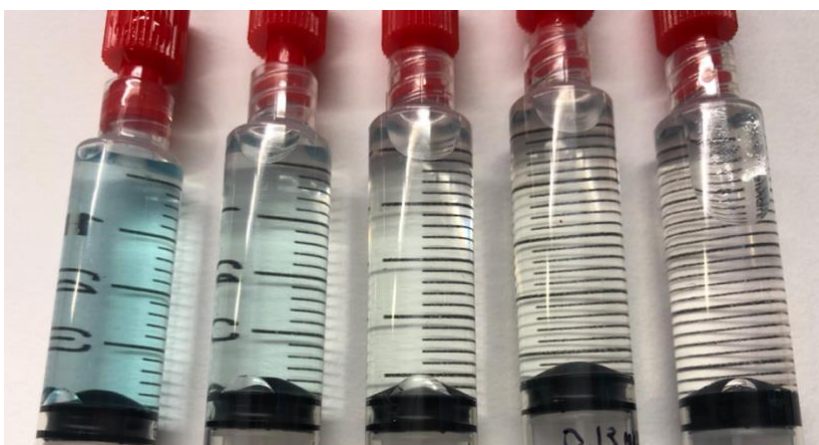
Figur 30: Konsentrasjonen til løsningen i sprøytene fra venstre til høyre er 1 mg/L, 0,5 mg/L, 0,25 mg/L og 0,13 mg/L. Sprøyten lengst til høyre er en tilfeldig sprøyte som har gjennomgått integritetstesting (eget bilde).
