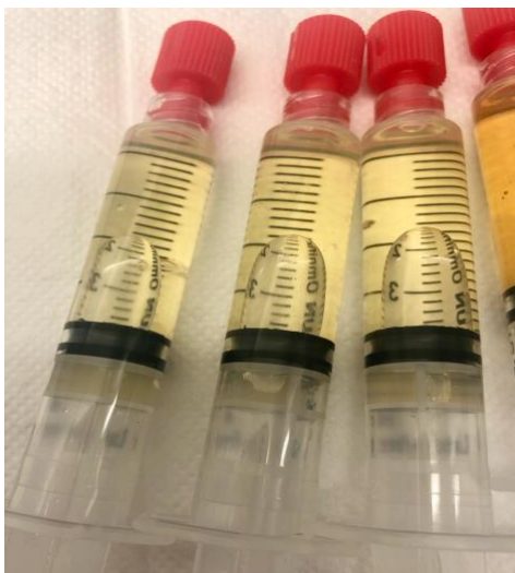
Figur 24: Bildet viser eksempel på sprøyter fra B. Braun Omnifix der det har samlet seg bakteriesuspensjon i toppen av stempelet etter en integritetstest (eget bilde).
