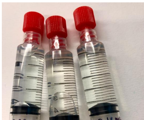
Figur 31: Bildet viser sammenligning av fargen i en sprøyte etter integritetstesting (sprøyten i midten) med en sprøyte med konsentrasjon av metylenblått på 0,25 mg/L (sprøyten til venstre) og en sprøyte med konsentrasjon av metylenblått på 0,13 mg/L (sprøyten til høyre) (eget bilde).
