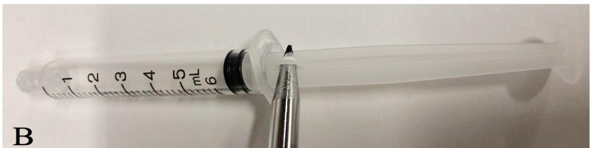
Figur 13: Figur som viser tillaging av hull i stempelet til sprøyten. (A) Figur fra protokoll (20). (B) Eget bilde.
