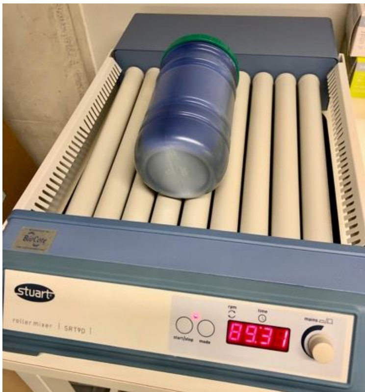
Figur 18: Bildet viser flasken med sprøytene og metylenblått på roteringsmaskinen under en integritetstest (eget bilde).
