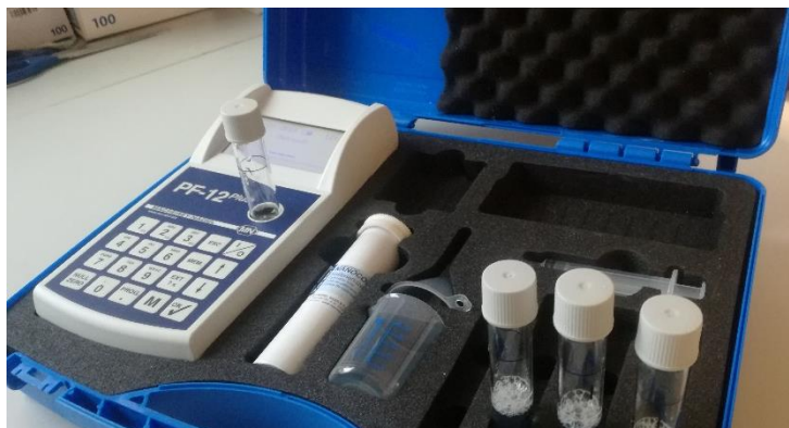
Figur 3-8: Kompaktfotometer PF-12plus som ble benyttet for å måle nitrat og fosfat innhold i de ulike avfallskildene. Foto: Sara Carolin Rundqvist
