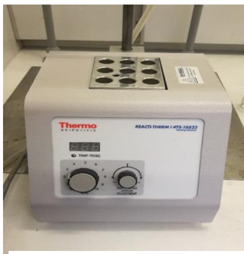
Figur 3-7: Thermo Scientific fordampneren som ble brukt til å tørke pelleten under tilførsel av nitrogengass. Foto: Sara Carolin Rundqvist
