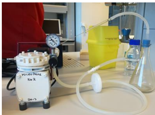
Figur 3-6: Glasspipette koblet sammen med en kolbe og en pumpe. Utstyret ble brukt til å fjerne supernatant fra fettsyreprøvene. Foto: Sara Carolin Rundqvist
