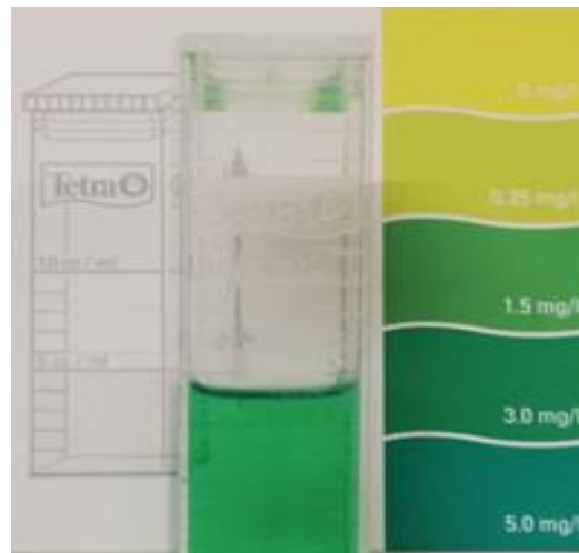
Figur 3-9: Kyvetten plassert ved siden av fargeskjemaet for å sammenligne fargeforandring, og avlese innhold (mg/L) av ammonium i prøven. Foto: Sara Carolin Rundqvist
