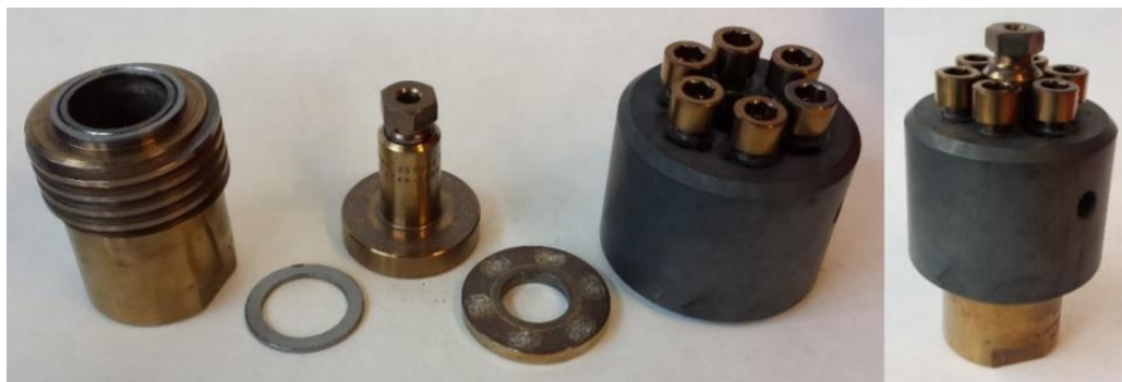
Figur 4.3: Til venstre er et bilde av alle delene til reaktoren, mens bildet til høyre viser en sammensatt reaktor. [13]
