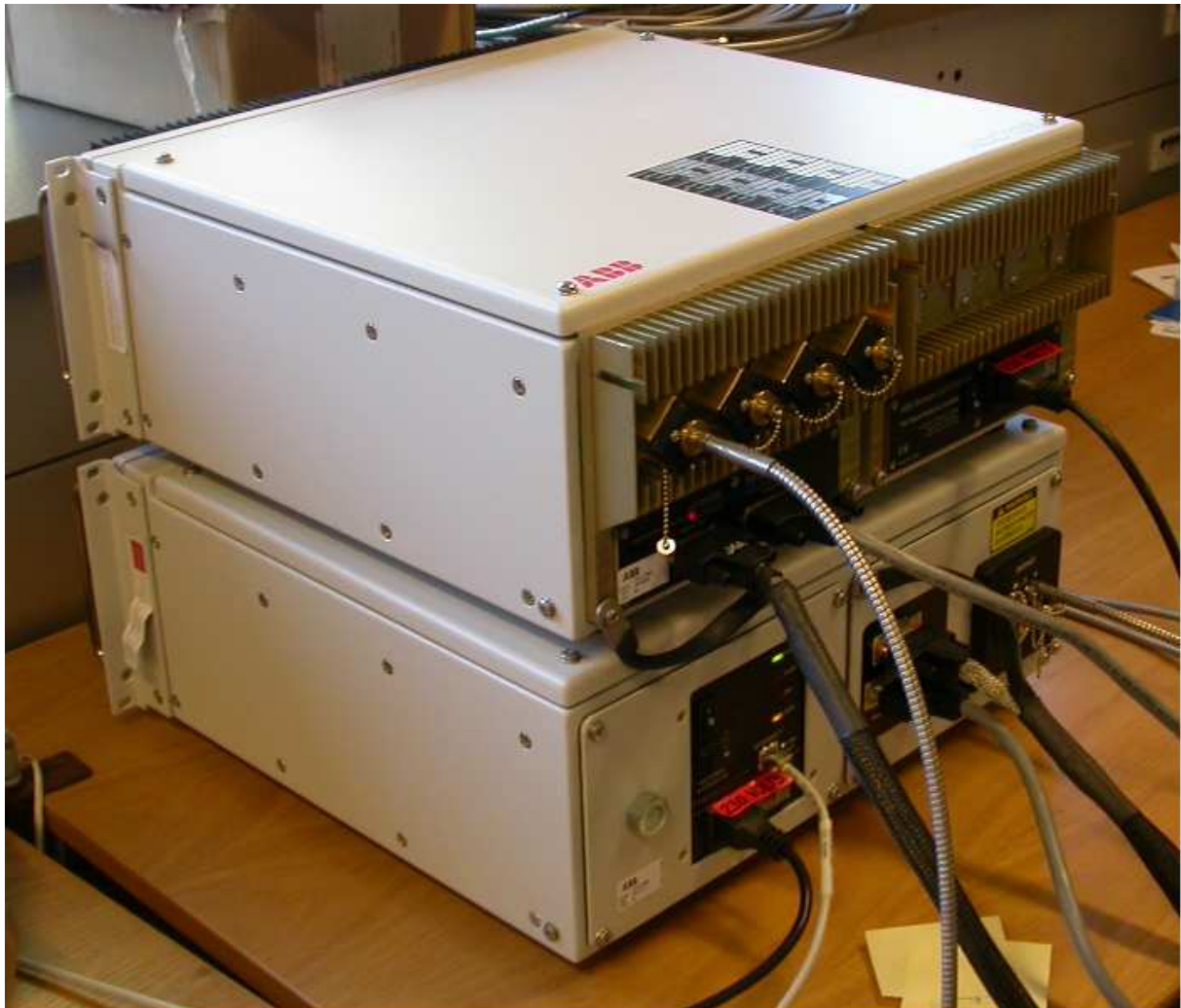
Figur 2.10: Måleinstrumentet som er benyttet i denne oppgaven. Utmodulen er underst, innmodulen er øverst.
