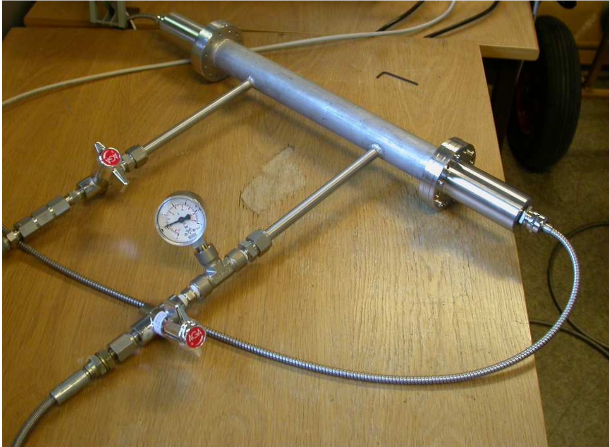
Figur 2.9: Prøvebeholder/ målecelle benyttet i denne oppgaven.
