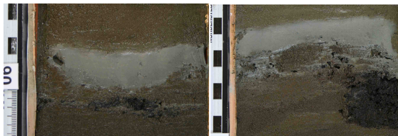
Figur 4.15: viser lag 1, 4 og 9. Målestokk t.v. for lag viser centimetermål. Lagene er jevne og uten organisk lag internt i den minerogene bestanddelen. Lag 1 er bøyd ved uttak med en piston corer. Dette viser to oppfiningssekvenser (mørk til lys farge) Lag 5 vises under lag 4.
