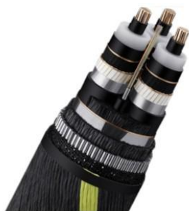
Figur 4-1 Elektrisk overføringskabel av typen 6/10 (12) kV, 3 leder kopper XLPE kabel, Cu skjerm [22].
