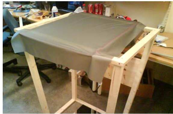
Figur 12: Lerretsstoff festes på undersiden av pleksiglassplaten på MT-bordprototype 1
