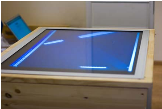
Figur 11: Pleksiglassoverflate med LED-ramme på MT-bordprototype 1
