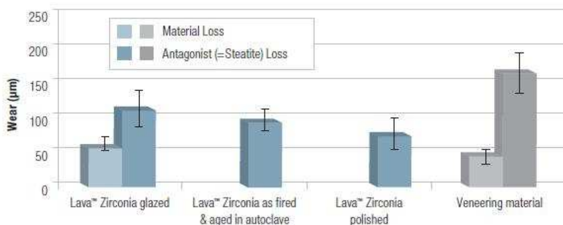
Figur 11. Forskjell på slitasje ved ulike overflatebehandlinger av zirkonia samt mellom monolitisk zirkonia og dekkeram (8).
