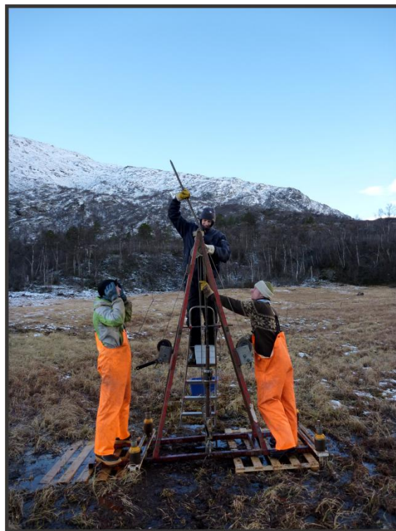
Figur 7: Stempelprøven vart henta opp ved hjelp av eit 110 mm breidt og 2 m langt PVC-røyr som pressast ned i myra med handmakt. Foto: Aril Løge Håvik.
