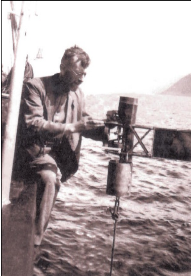
Figur 4. Ekman prøver ut sin repeterende strømmåler fra Armauer Hansen . (Bilde fra Bergens geofysikeres forening).
