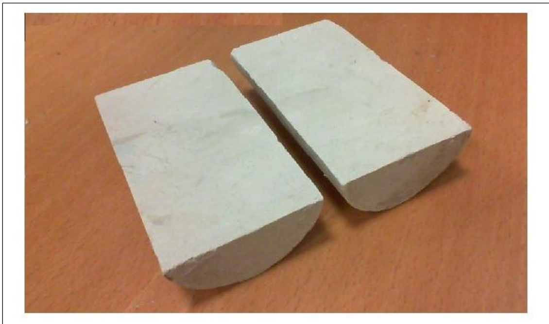
Figur 8.3: Et eksempel på en oppsprukket kjerneprøve etter flømming med flytende CO 2 i en sekundær utvinningsprosess.
