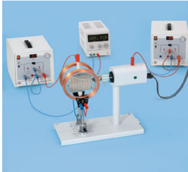
Figur 3.1: Bilde som viser alle koblinger. To endringer ble foretatt; spolene ble koblet i serie og et amperemeter ble koblet i serie med disse og lavspenningskilden. Høyspenningsskilden til venstre kalles for høyspenningsskilde nr. 1 og den til høyre kalles for høyspenningsskilde nr. 2 videre i denne oppgaven. Bilde: Leybold Didactic [1].
