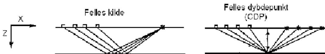
Figur 4.3: Geometrien til strålebanene for en felles skuddsamling (venstre) og en felles midtpunkt samling (høyre) (Skissert fra Sheriff & Geldart, 1995).
