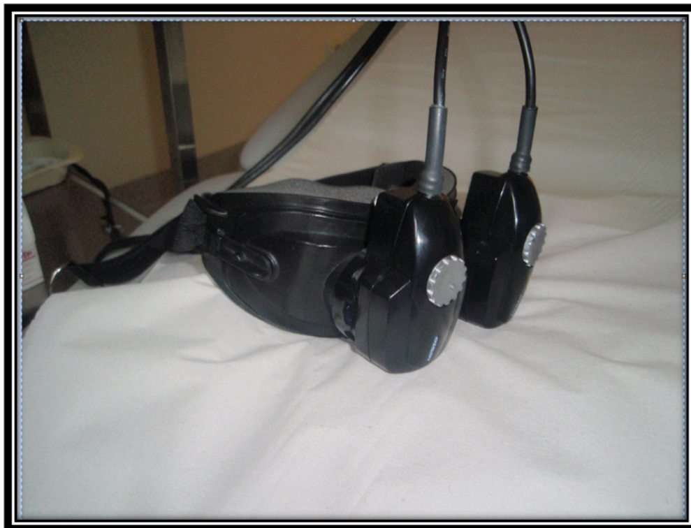
Bilde 2. Maske med to infrarøde kameraer (videonystagmography)
