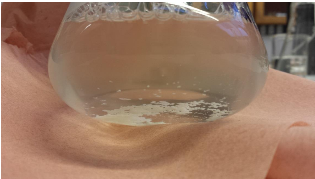
Figur 4.7-1: Bilde som viser produsert surfaktantløsning ved 2.4 m % NaCl.
