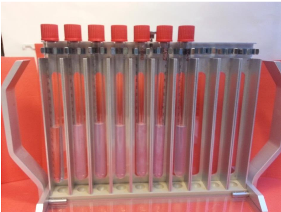
Figur 4.1-1: Turbiditet som funksjon av salinitet. Fra venstre (m % NaCl): 0.4, 1.6, 2.0, 2.4, 3.6, 4.0 og 5.0.
