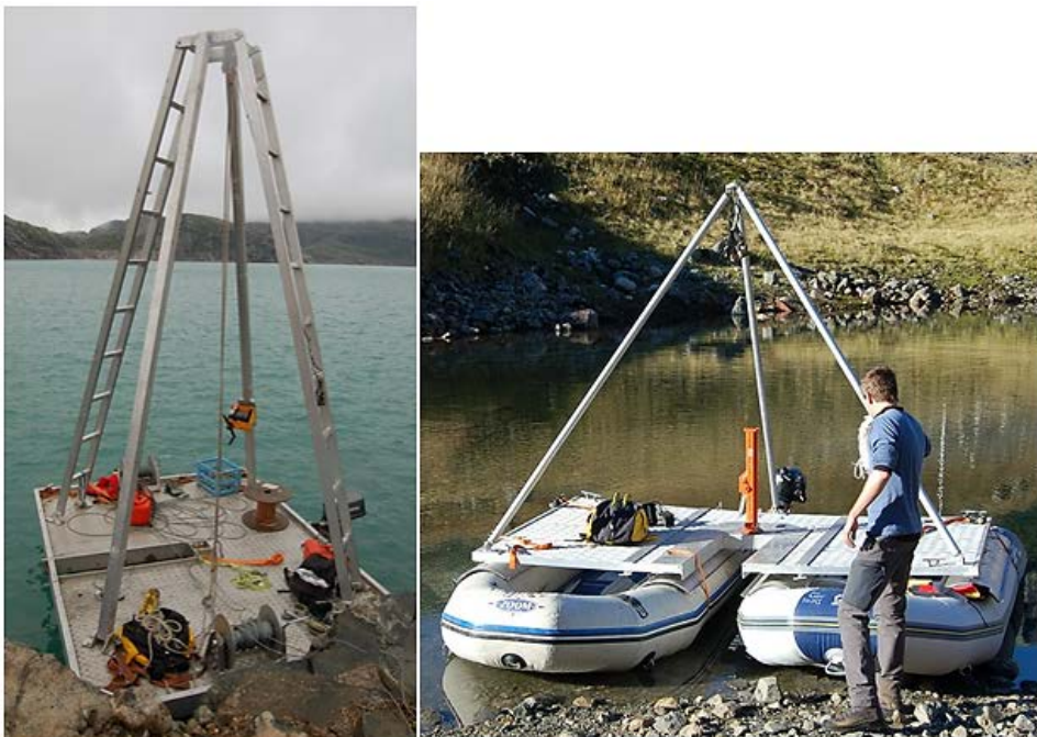
Figur 3. 1 Bildet til venstre viser flåten med tårnet som stempel-prøvetakeren monteres i. Denne ble brukt for å hente opp kjernene fra Juklavatnet. Til høyre vises flåten som ble brukt i Markjelkevatnet. Denne er noe mindre enn den til venstre, men benytter de samme prinsippene.
