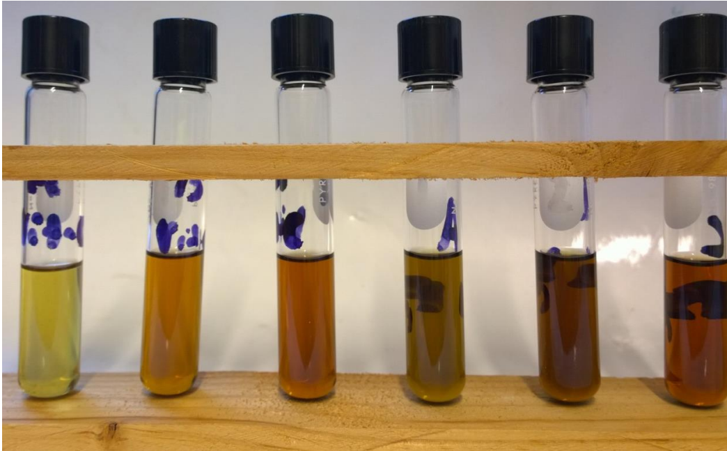
Figur 3. 5 – Fremstille partikler i mikroemulsjon. Fra venstre; prøve 1, 2 og 3 fra tabell 3.10 og 3.12, fremstilt med askorbinsyre som reduksjonsmiddel, etterfulgt av prøve 1,2 og 3 fra tabell 3.10 og 3.11, fremstilt med natriumborhydrid som reduksjonsmiddel
