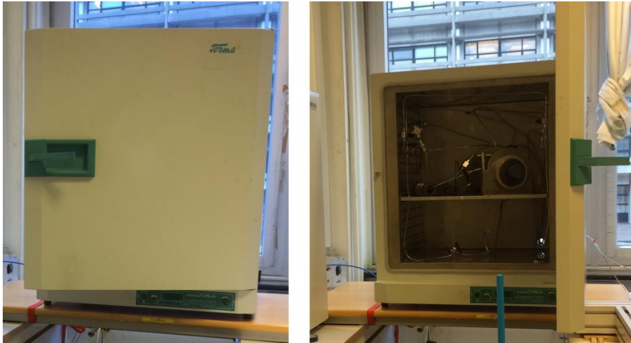
Figur 4.11: Varmeskap med kjerneholder under oppbyggingen av oppsettet.
