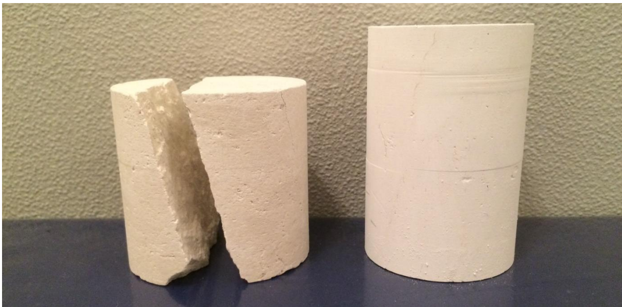
Figur 4.2: En oppsprekt kalkkjerne etter injeksjonsforsøk til venstre. En tørr kalkkjerne til høyre.
