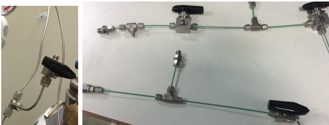
Figur 4.13: Ståltubing og grønn PEEK-tubing med ventiler og koblinger.
