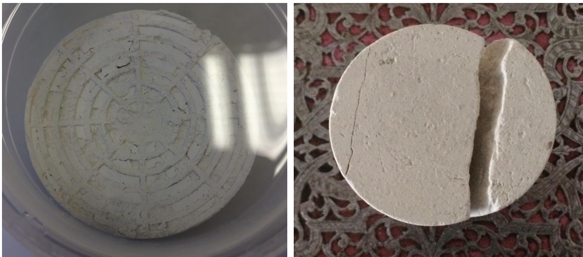
Figur 5.20: Observert vannsvekkende effekt på kalkkjerener som følge av vanninjeksjon - oppløsning og oppsprekking.
