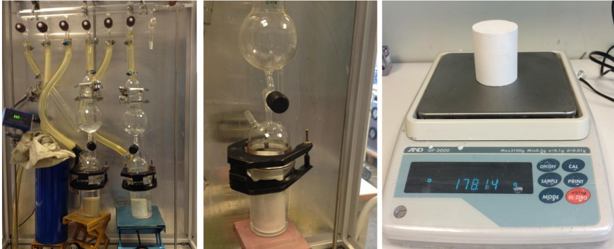
Figur 4.3: Fra venstre: kjerneprøver under vakuumering, metning og veiing.
