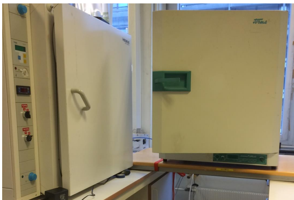
Figur 4.6: To varmeskap, der skapet til venstre ble forsøkt brukt til nedkjøling av injeksjonsvann og skapet til høyre ble brukt til å varme opp kjerne.
