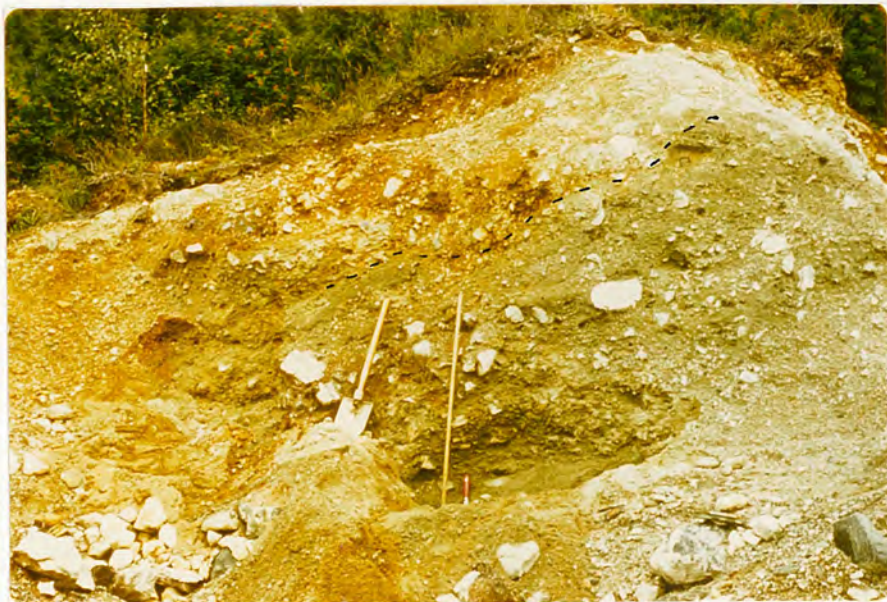
Fig. 49. Snitt i rygg D. Övst viser snittet skarpkanta materiale med jernutfelling. Lengre nede ligg morene med bedre runda materiale. Nedst viser snittet eit sandparti. Den stipla lina markerer nedre grense for det övre materialet.
