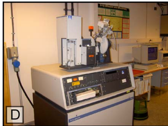
Figur 1: Bildene viser deler av prosessen med behandling av prøver før og under XRD-analysen, samt noe av utstyret som ble brukt. (A) Her vises materiale i suspensjon klar til helles opp i sylindere. (B) Prøver klar til behandling med etylenglycol i varmeskap i et døgn. (C) På bildet vises muffelovnen (D) Analysemaskinen.
