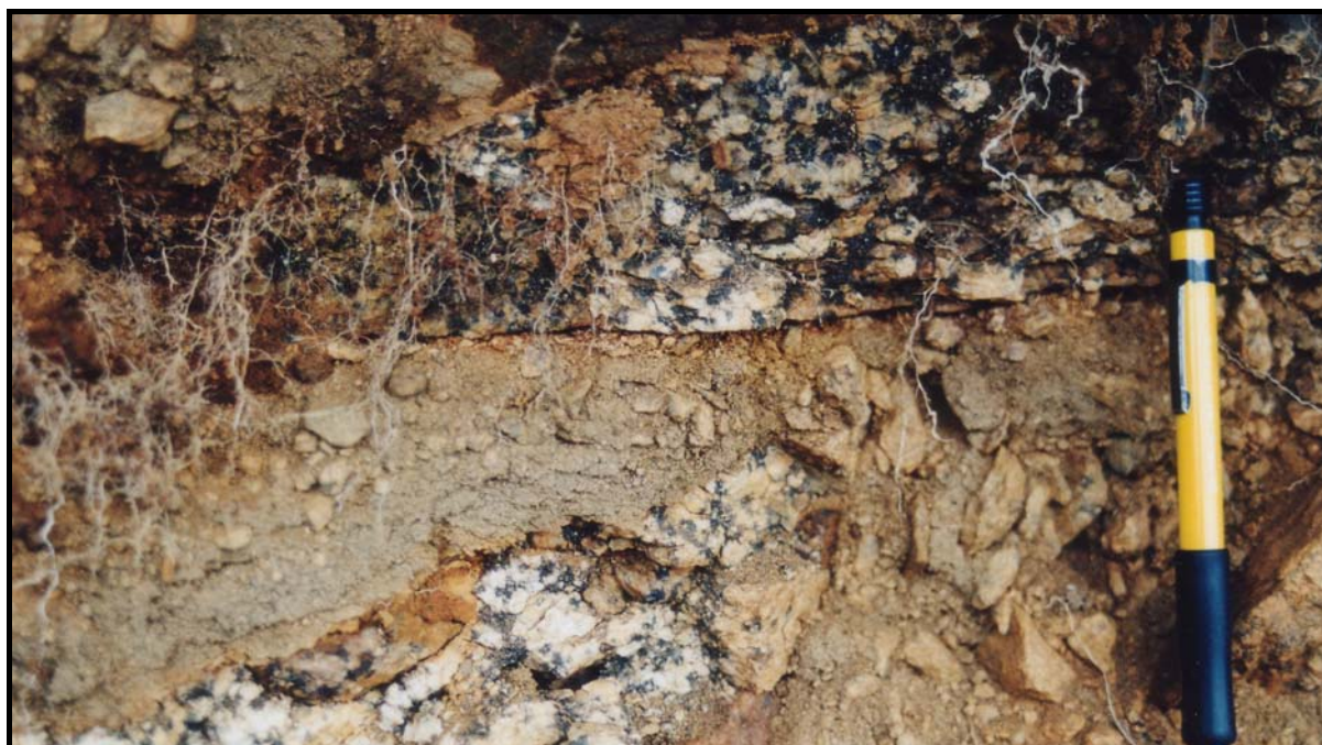
Figur 5-1: Forvittringsprofil fra Loftskanten som viser store forskjeller i forvittringsgrad innenfor små avstander i den monzonittiske gneisen på stedet. Det midtre laget kan karakteriseres som pedolitt, mens det over- og underliggende laget består av grusig saprolitt. Se penn for skala.
