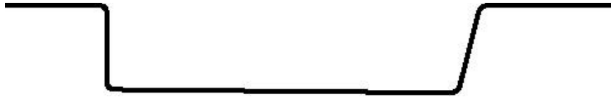
Figur 4.1: En god elvekanal bør ha denne trapesoidiske formen.
