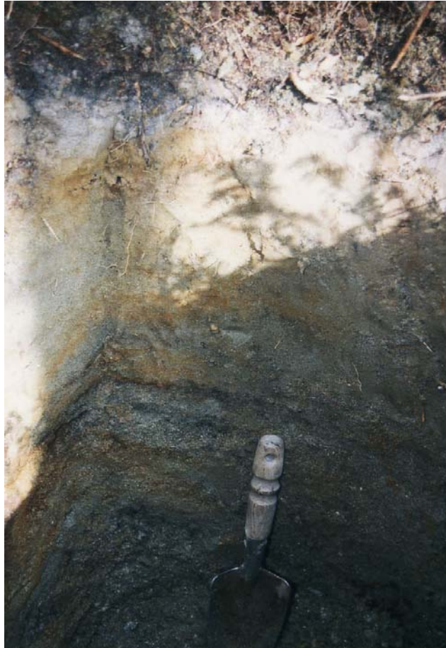
Bilde 6.4: Under torven finnes store mengder med sand ned til rundt 1 m dyp, og der blir sedimentene for grove til å grave i. Det er gode forhold for tuedannelse.
