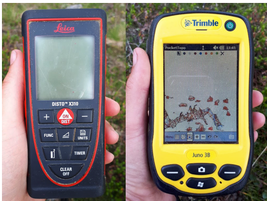
Figur 4.1: Utstyret som er nytta til kartleggingen av grottene. Venstre: laser avstandsmåler (Leica Disto™ X310). Høgre: handheld datamaskin (Trimble Juno 3B), med kartleggingsprogramvara PocketTopo.
