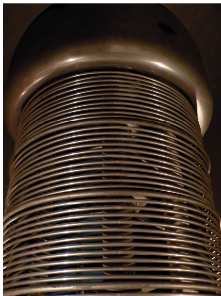
Interiør fra Van de Graaff-generatoren Foto: Ola Søndena
