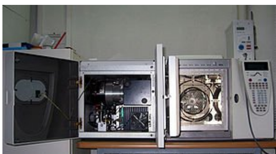
Figur 3.2: Innsiden av GC/MS- apparaturen, der man kan se gasskromatograf- kolonnen i ovnen til høyre [ http://en.wikipedia.org/wiki/Gas_chromatography-mass_spectrometry ].
