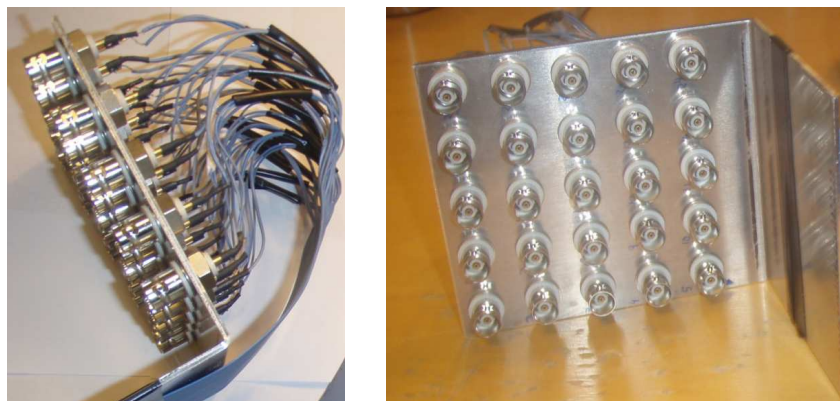
Figur 3.9: Flatkabelen er loddet fast i et panel bestående av 25 BNC-plugger
