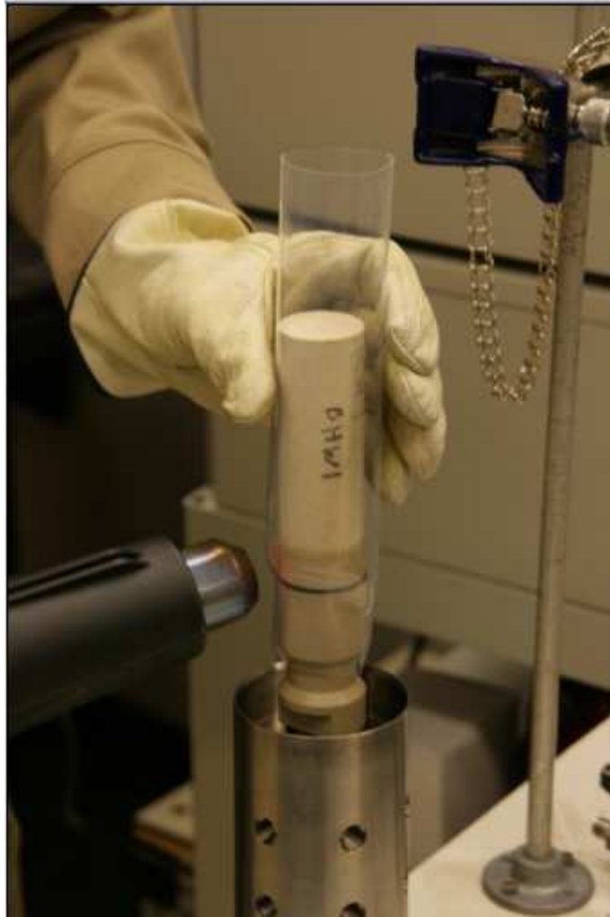
Figur 3.2 – Installering av kjerne med krympehylse.
