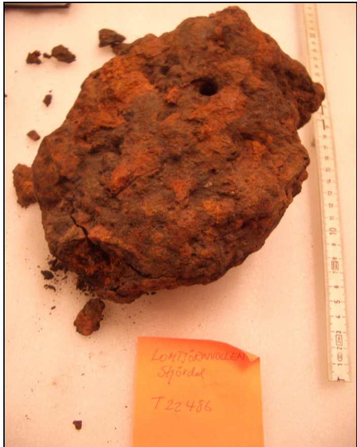
Figur 7.6: Luppen funnet på Lomtjørnvollen. Kvaliteten på jernet kan ikke ha vært høy, den var den mest forvitrede luppen.. Foto: Joakim Wintervoll
