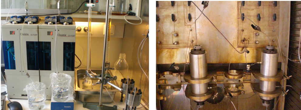
Figur 3.8.1: Oppsett av høytemperaturflømming. Venstre: Viser pumpene som ble brukt og imbibisjonscellene som fluidene ble samlet opp i. Baktrykksregulatorene er til høyre på bildet. Høyre: Kjerneholderne som ble installert i varmeskapet.
